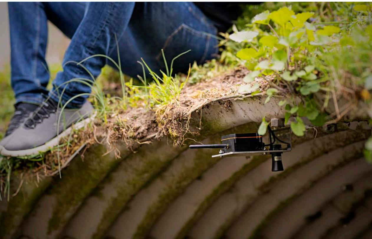
*LoRa-Sensor für die Messung des Wasserpegels*
