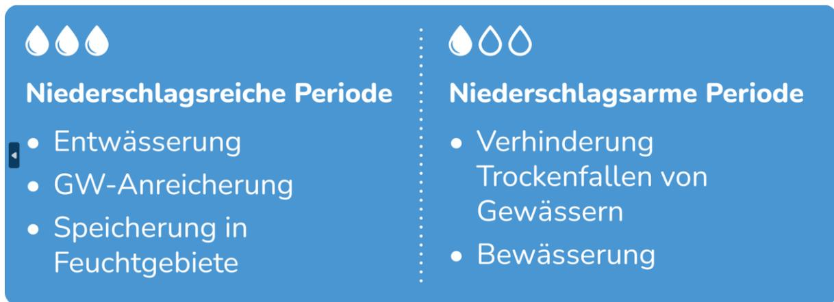
Abbildung 35: Ziel des gezielten und gesteuerten Wasserrückhalts in Entwässerungsgräben
